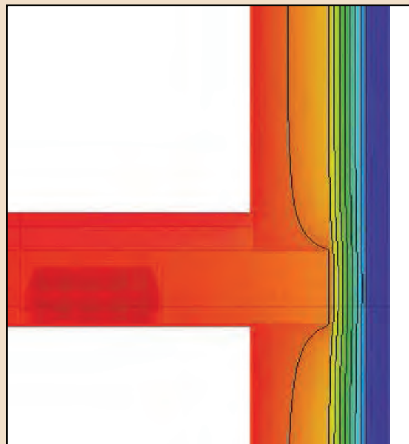
Esempio di ponte termico del particolare cordolo-trave-muratura.
