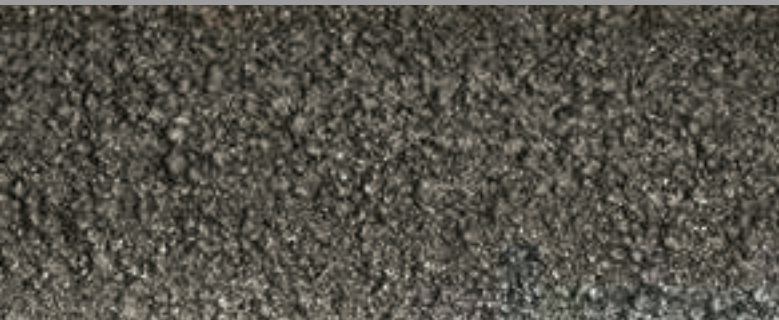
Tappeto bituminoso fonoassorbente con argilla espansa
