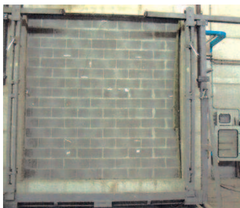
Foto del lato non esposto al fuoco dopo la prova.
